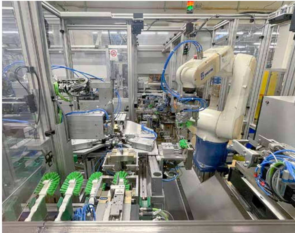
Im Eigenbau automatisiert: Die eingedrehte Bürsten-«Raupe» wird hier in den WC-Besen verschweisst, damit ein WC-Besen mit Randreiniger entsteht. Bild: Ebnat AG
