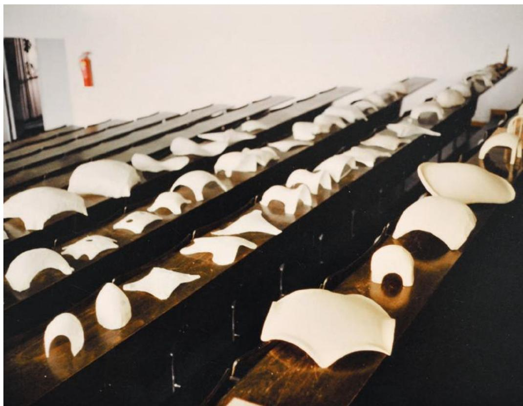
1 Modelli didattici creati durante i laboratori di Heinz Isler con i suoi studenti: una collezione di forme architettoniche in gesso, esposte su banchi, che riflettono le innovative esplorazioni di Isler nel campo delle strutture sottili e del calcestruzzo. Fonte gta Archiv / ETH Zürich (archivio Heinz Isler)
