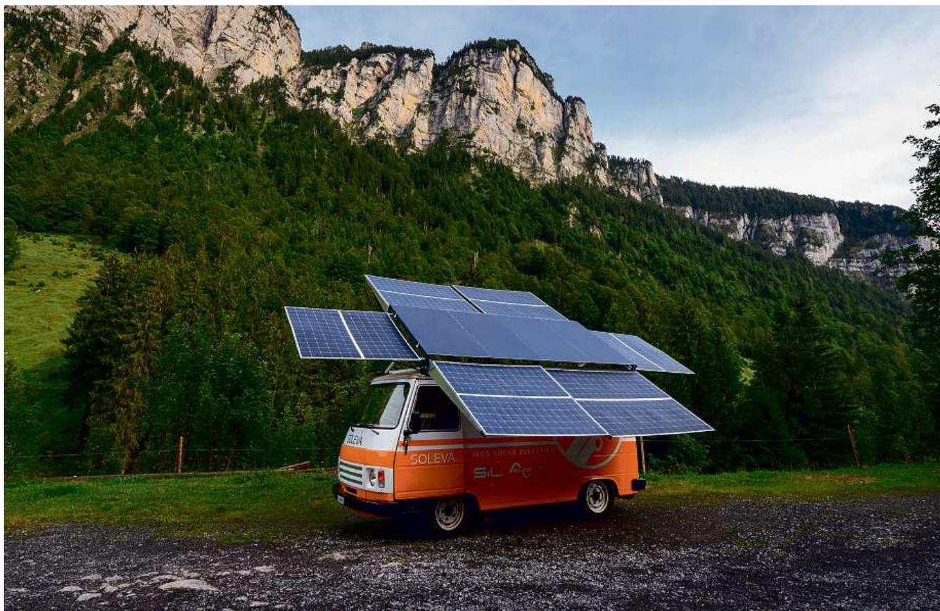
À l'arrêt, les panneaux solaires du van sont déployés et inclinés pour favoriser la production PV.
