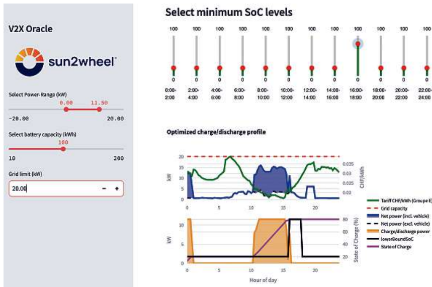
Bild 2 Der Pick-Up SoC ist zu einer bestimmten Zeit vorgegeben.
