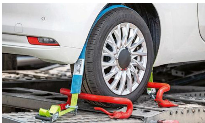
Angebrachtes CarFix ZT 35 mit integriertem Wirbelhaken, Controller (blau) mit sichtbarem Label und Radvorleger (rot).
