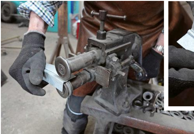
Werner Haas demonstriert die kurbelbetriebene Sickenmaschine. Werner Haas présente la moulurière à manivelle.
