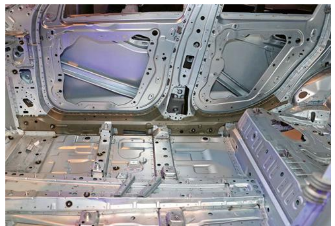
Der Blick auf den Bereich Boden Mitte bei der vollelektrischen Version lässt die flachen Sitzquerträger, den Tunnel und das dunkle PHS-Verstärkungsteil am Schweller erkennen.
