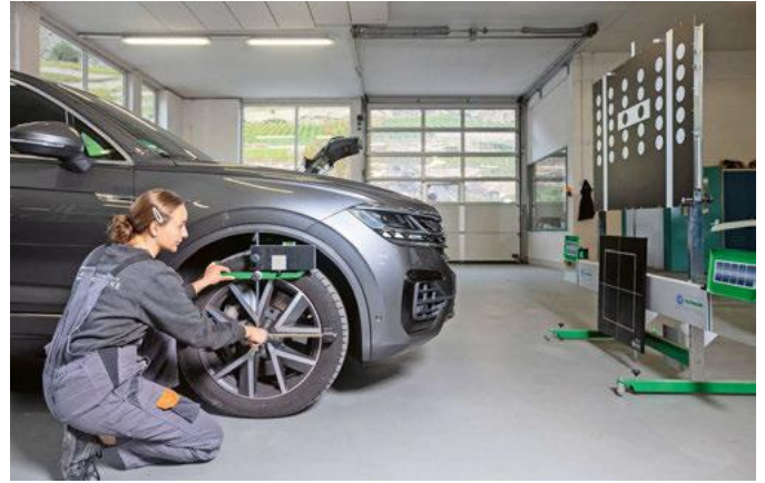
Carrosseriespenglerin Julie am ADAS-Sensor-Kalibriersystem.
