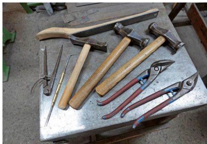
Das waren die Werkzeuge eines Carrosseriespenglers im Carrosseriebau der 1960er-Jahre.
