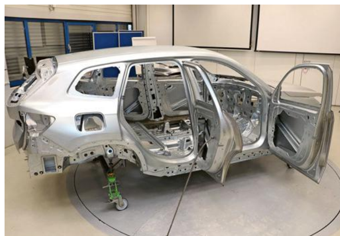
Die verzinkten Bleche der Carrosserie des X1 werden mit Punktschweissen und Klebstoff zur Carrosserie gefügt.
