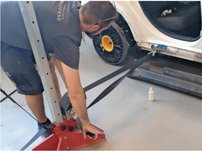
Hier wird ein Schweller ebenfalls mit ABOL-Klebertechnik wieder in seine ursprüngliche Form gebracht.
