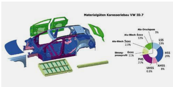
Materialgütern an der Carrosserie des VW ID.7 (Quelle Volkswagen) Qualités des matériaux sur la carrosserie de la VW ID.7 (Source VW)
