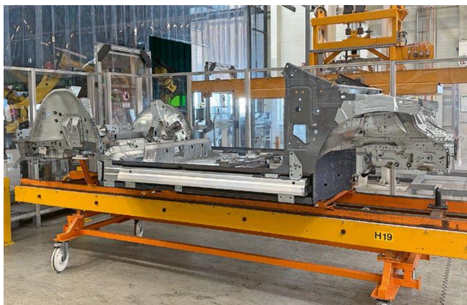
Nur in der Produktionshalle zu entdecken: die Bodengruppe mit den dunklen, warmumgeformten Blechen und das Aluminium-Verstärkungsprofil im Schweller mit seinen Ankerblechen. (Quelle: Volkswagen)
