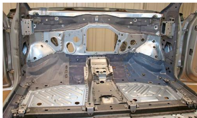
Im Innenraum zeigt die Bodengruppe vorn ihren hohen Anteil an warmumgeformten Blechen und die Sitzquerträger mit einer 1900 MPa Materialgüte.
