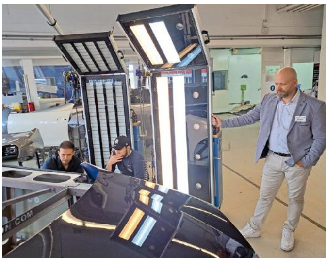
Clint Kaufmann, Technischer Leiter und Produktmanager von Axalta Schweiz, präsentiert die Visomax Coating Finish Station mit LED-Oberflächenkontrollleuchten.
