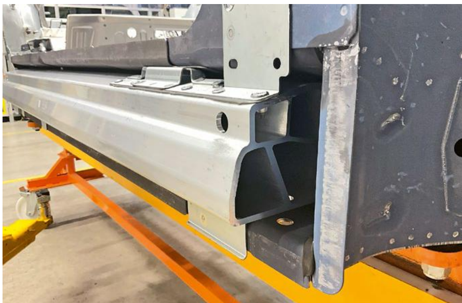
Das 6-Kammer-Strangpressprofil im Schweller schützt Insassen und die HV-Batterie bei einem Seiten- oder Frontcrash. (Quelle: Volkswagen)
