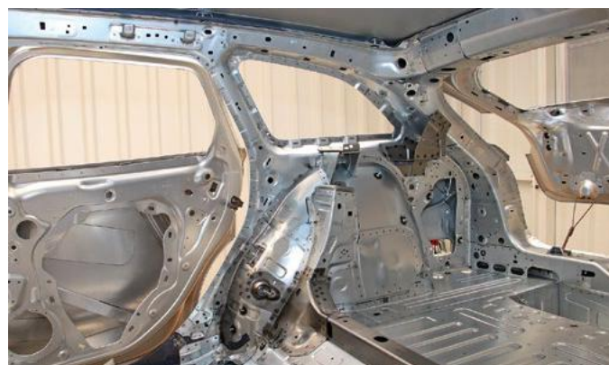
Stahlbleche dominieren den Carrosseriebau des ID.7, hier der Hinterwagen innen mit Radhaus, Längsträger und Kofferboden.
