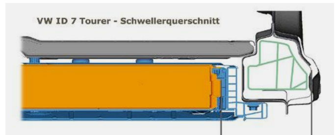
In der Querschnittsgrafik lassen sich der grosse Deformationsraum und das 6-Kammerprofil klar erkennen, die bei einem Seitencrash die HV-Batterie vor Beschädigung schützen. (Quelle Volkswagen)
