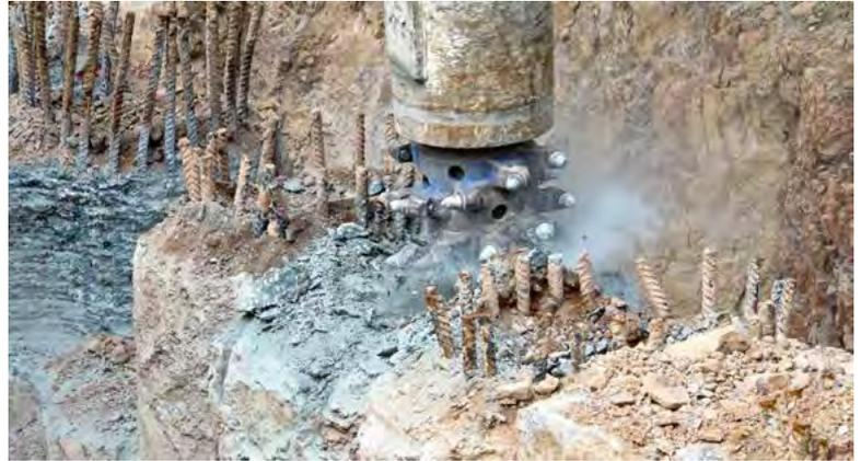
Die robusten Spezialanbaufräsen werden im Rückbau und im Spezialtiefbau eingesetzt.
