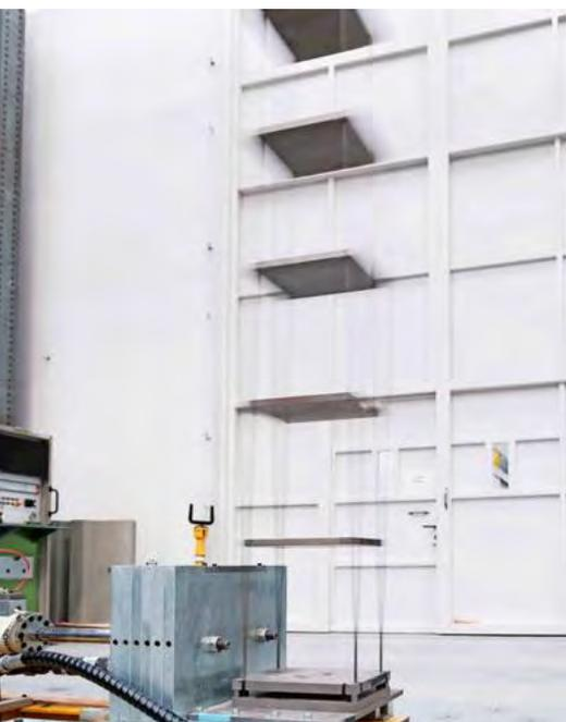
Miniatur-Erdbeben: Der «Shaker» versetzt ein Tragwerksmodell in Schwingung.
