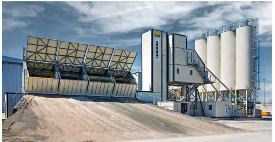
Liebherr-Mischanlage vom Typ Mobilmix 2.5 liefert den Beton für das Fertigteilwerk.
