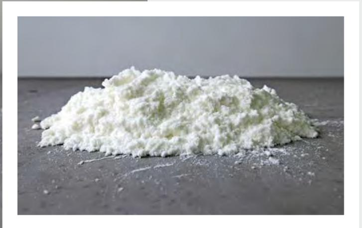
Die extrem feinen Naturfasern verteilen sich beim Mischen im Frischbeton und bilden ein sehr dichtes Fasernetz.
