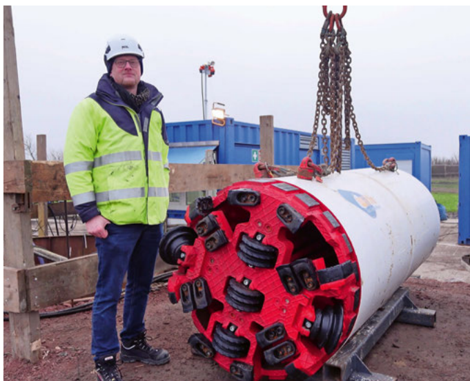
Bei diesen Arbeiten kommt ein sogenanntes Microtunnel-Bohrgerät zum Einsatz. Das Bohrgerät schafft eine Bohrung für ein Mantelrohr mit einem Aussendurchmesser von 960 Millimetern.
