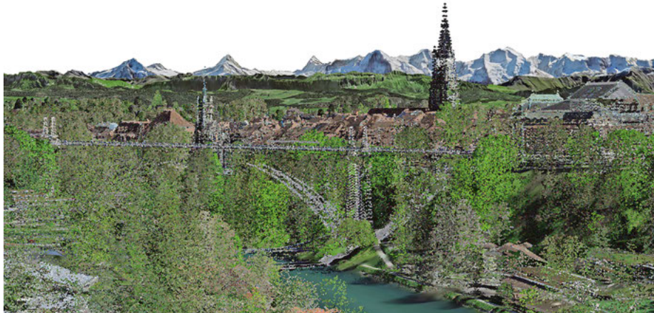
Das Bild zeigt eine klassifizierte LiDAR-Punktwolke in der Umgebung der Berner Altstadt.
