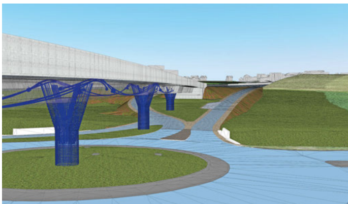
3D-Modell Brücke Gibelfeld mit Vorspannung und Armierung (CAD/BIM-Software ALLPLAN).
