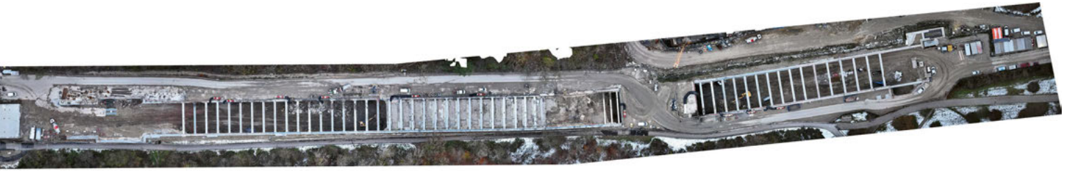
Drohnenfotos wie dieses ermöglichen den massstabsgetreuen Abgleich des Ist-Zustands mit der Ausführungsplanung.
