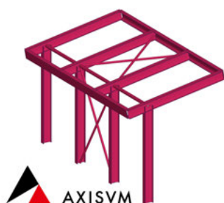
Ausschnitt des Tragwerks in AxisVM. (Quelle: Ingware AG)
