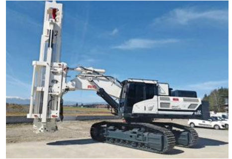
Der HD Hyundai HX 520 AL mit dem Impulsverdichter von Terra-Mix.
