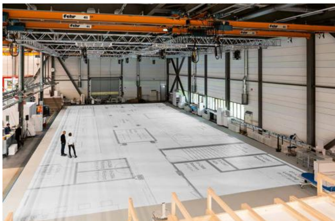
Auf maximal 560 Quadratmeter projizieren zwölf Beamer die Grundrisse von geplanten Gebäuden auf den weissen Bodenbelag.
