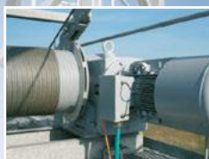
Stufenlose Hub- und Katzfahr- antriebe mit Umrichtertechnik und überwachter Sicherheits- bremse
