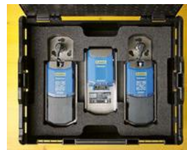
Der Sensor «DokaXact Pressure» übermittelt Livedaten zur Überwachung des Frischbetondrucks.
