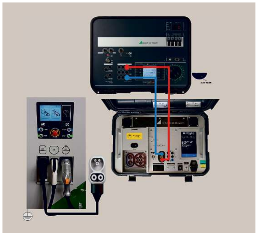
Aufbau für die Messung DC-Schleifenwiderstandes. Die Schleifenimpedanz sollte je Stromkreis an der entferntesten Stelle gemessen werden, um die maximale Schleifenimpedanz der Anlage zu erfassen.
