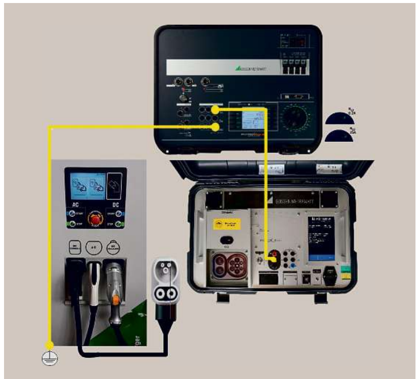
Messung der niederohmigen Durchgängigkeit des Schutzleiters im CCS-System mit 25 A. Aufgrund des hohen Prüfstroms kann dies bei geringen Querschnitten unter Umständen zu unerwünschten Erwärmungen oder Beschädigungen führen.
