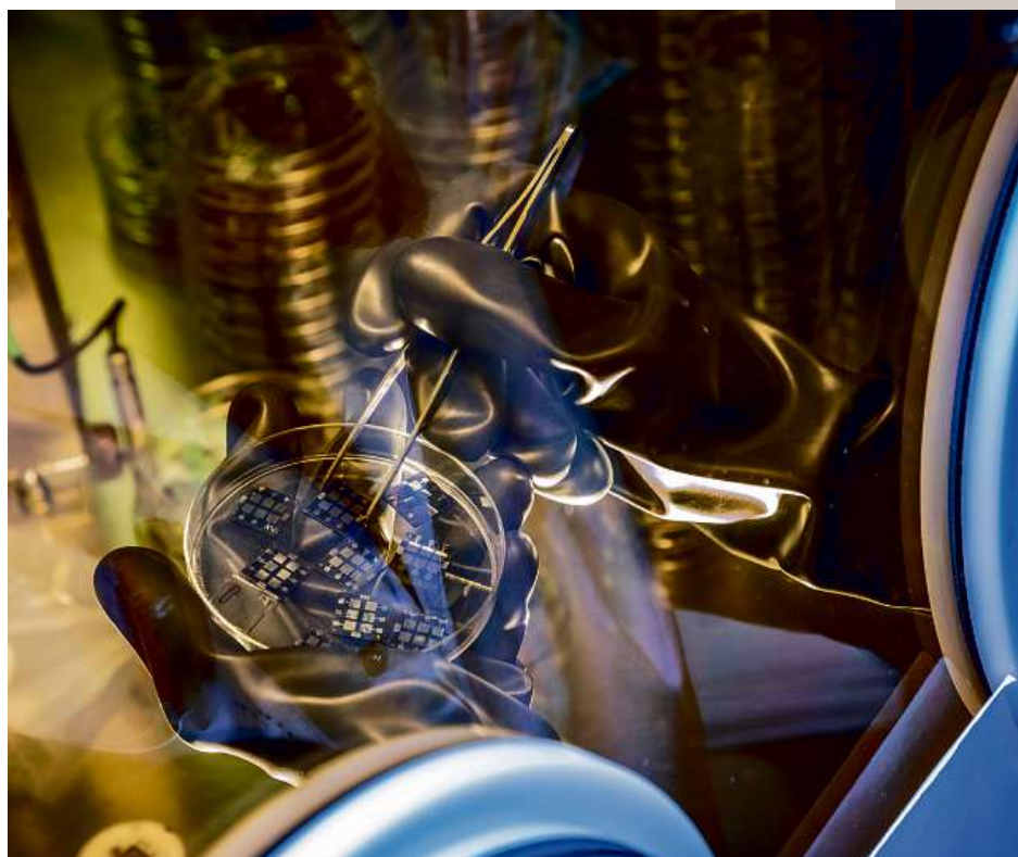
Organische Solarzellen in einer Glovebox, in der sie mit künstlichem Sonnenlicht bestrahlt werden.
