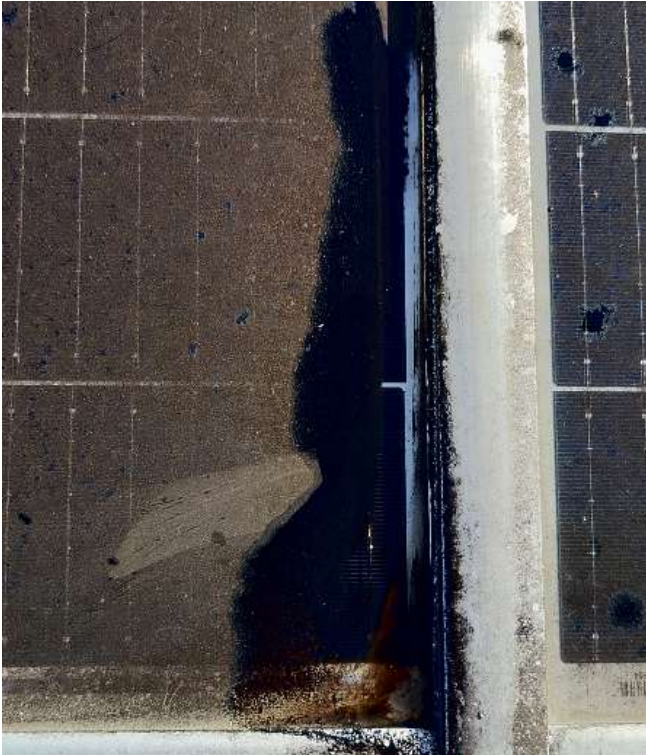
Verschmutzungsgrad nach 1,5 Jahren, Neigungswinkel 7°, mit diversen kleinen Putzversuchen.
