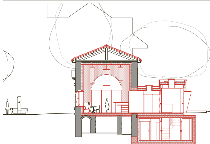
Coupe au travers de l'édicule historique et de l'extension
