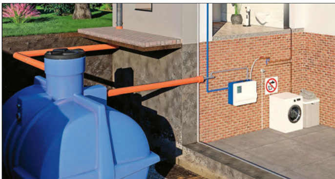
Die Regenwassermanagementsysteme Sanirain ermöglichen die Nutzung von Brauchwasser für WC-Spülungen, Waschmaschinen und Bewässerungssysteme.
