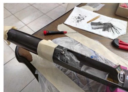
Reparatur der Flügelbefestigung auf dem Esstisch. Anschliessend wurde über Nacht im halboffenen Backofen getempert.
