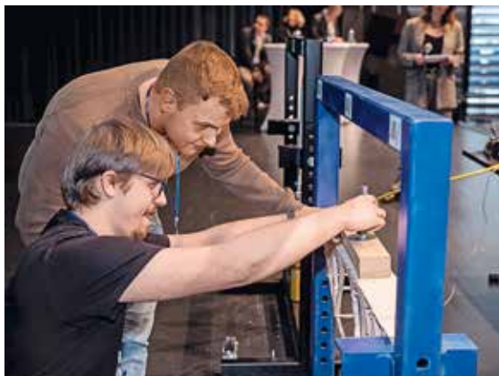
3 | Die präzise Platzierung des Druckschuhs auf dem Prüfstand ist wichtig.
