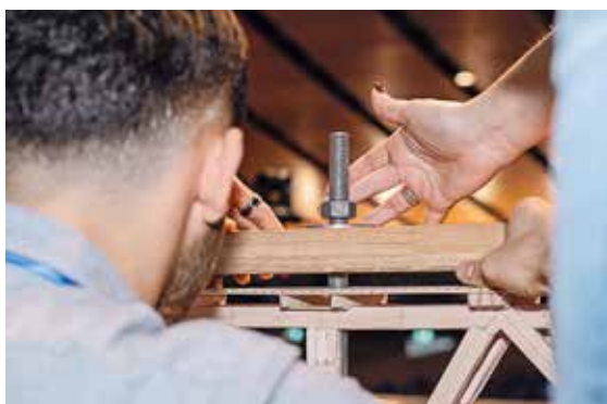
4 | Der Druckschuh ist platziert und wird festgeschraubt. Der Bruchtest kann beginnen.
