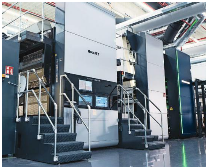
Die RotaJET, digitale Lösung für Verpackungsdruck, unter anderem zum Bedrucken von Toplinern. © Koenig & Bauer
