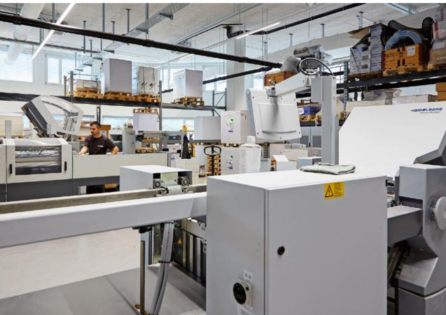
Die Weiterverarbeitung wurde erneuert. Neben dem Kauf einer neuen automatisierten Falzmaschine Stahlfolder TH 56-10 mit zehn Taschen wurde eine altgediente Kombifalzmaschine Stahlfolder KH 82-6 komplett revidiert.
