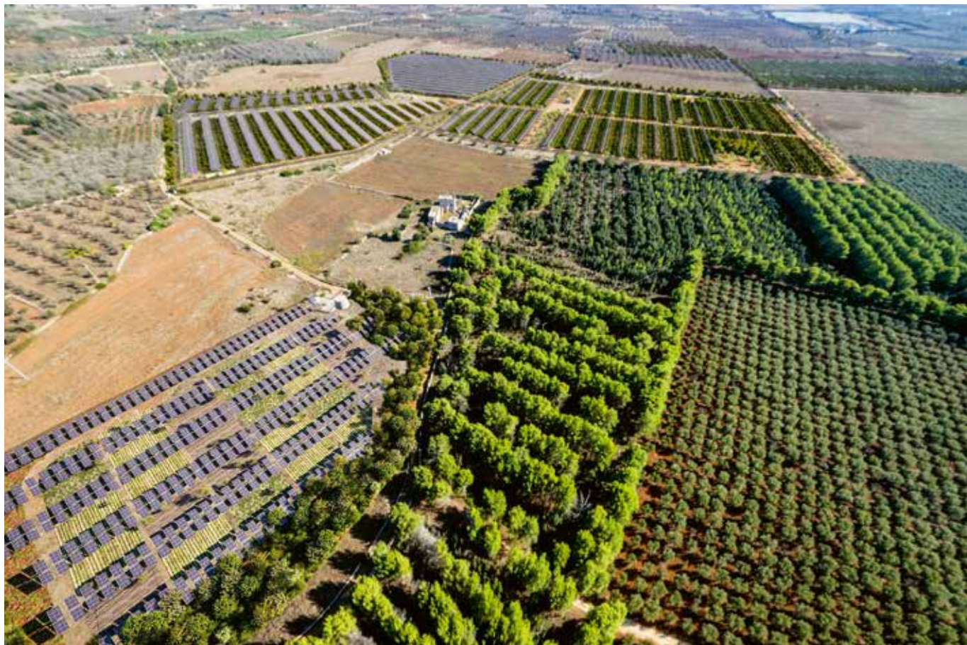
Projet agrivoltaïque « Santa Lucia » à Presicce-Acquarica (I) : d'une puissance de 24 MW, la centrale est installée dans le cadre d'un projet de régénération d'oliveraies touchées par la bactérie Xylella fastidiosa . (HOPE GROUP)
