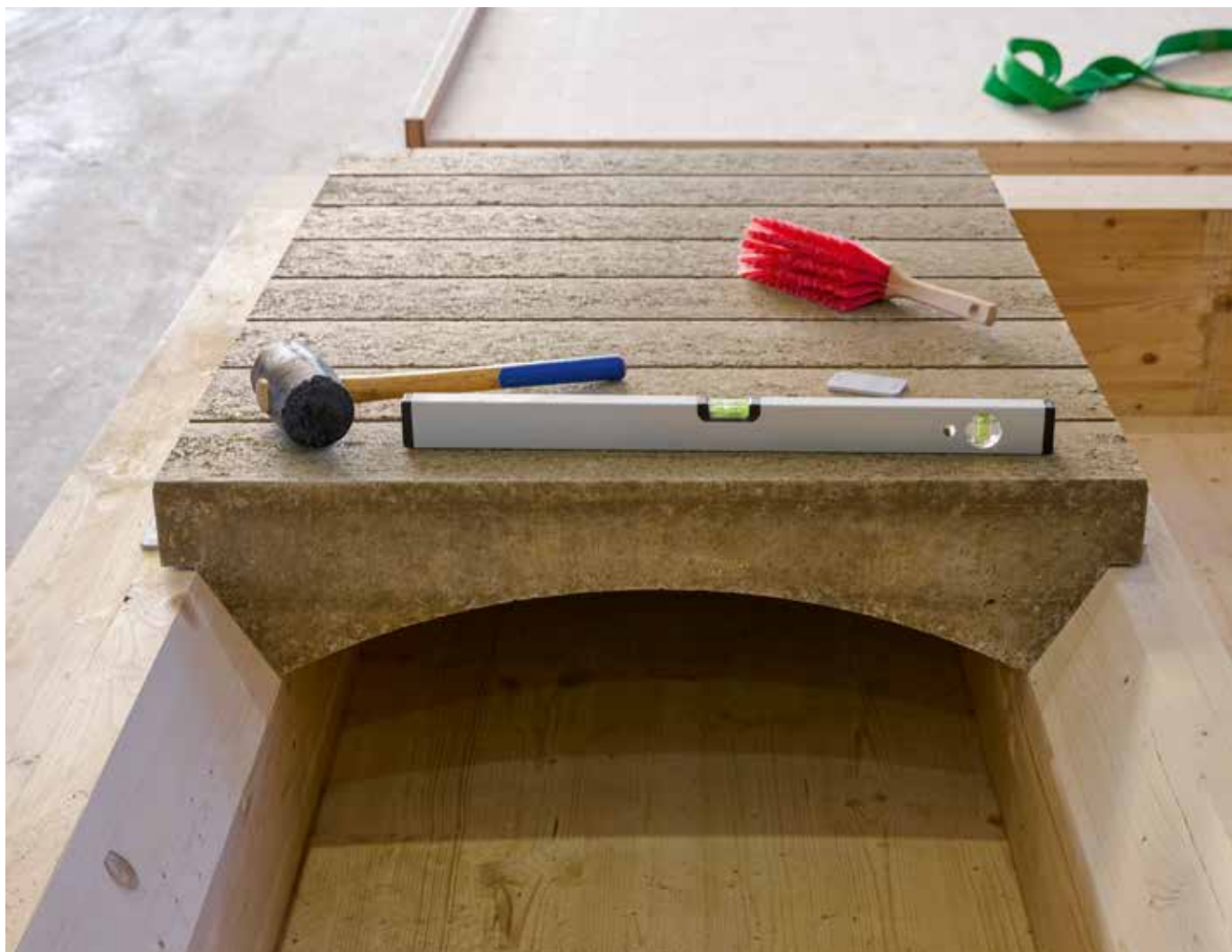
Essai en compression sur une travée de plancher réalisé au LEMS de l'HEPIA (GE) le 4 novembre 2024 (LEO FABRIZIO)
