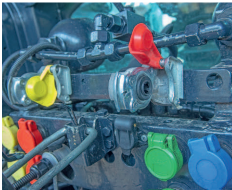
Les freins pneumatiques (en haut) gagnent du terrain sur les tracteurs.
