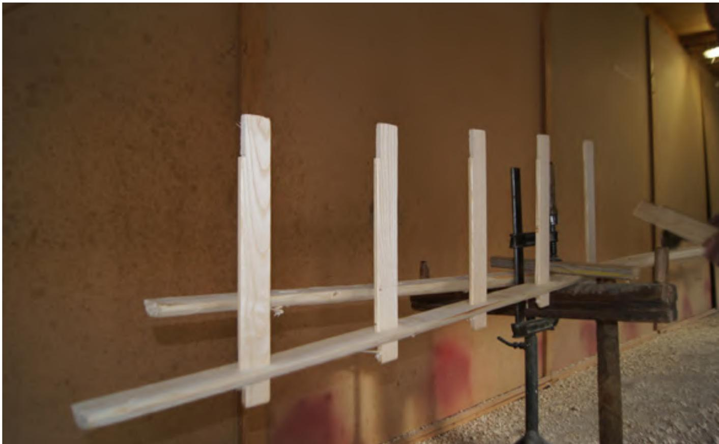
*En fonction de la destination des échelles, les barreaux faits à la main sont en chêne, en acacia ou en orme.*
