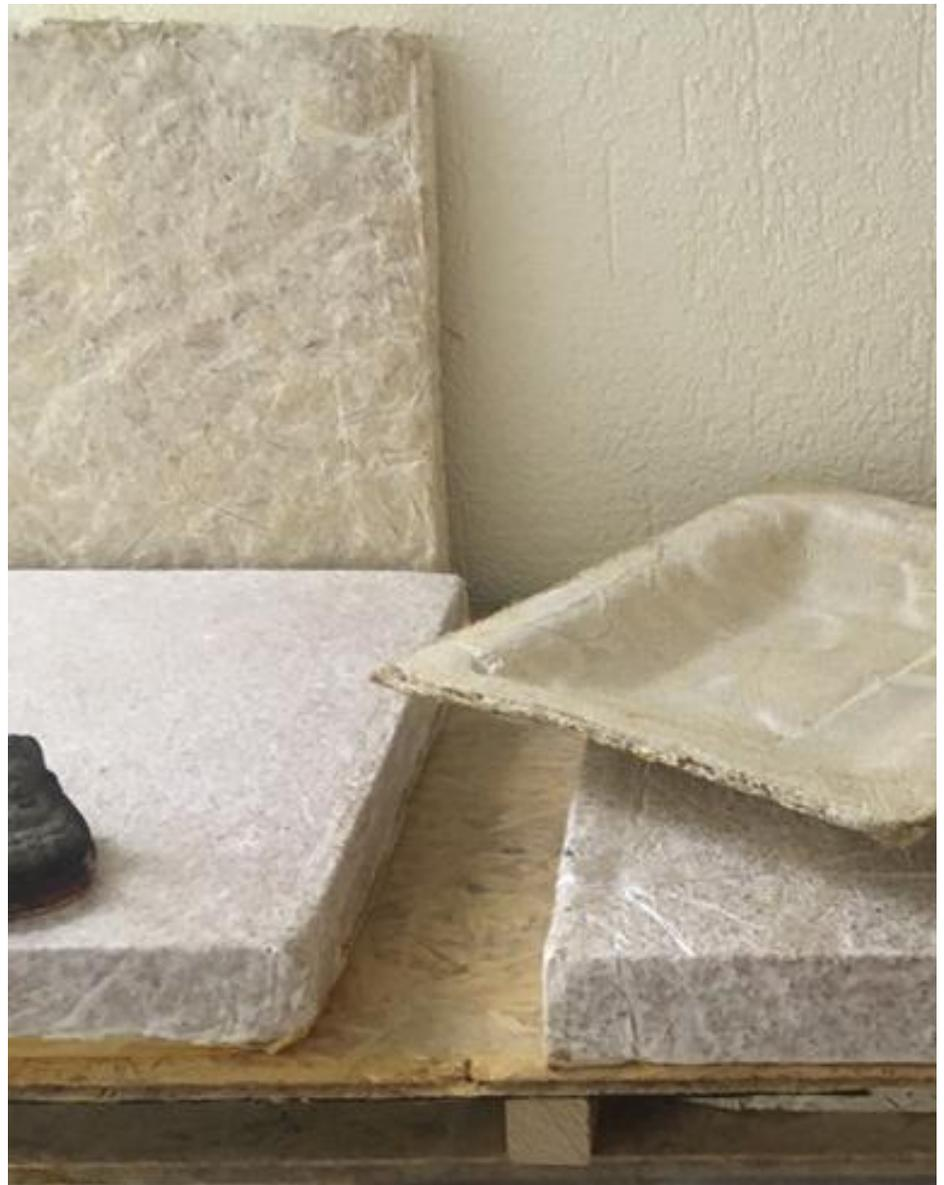
Panneaux de construction et objets design en composite de mycélium.
