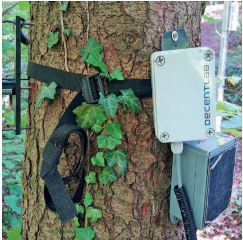
Mit Punktdendrometern wird die Ausdehnung des Stammes gemessen.
