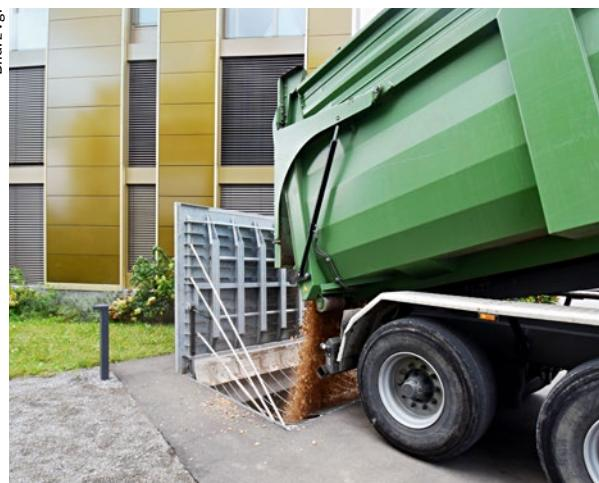
Ursprünglich wollte die GBL ein Blockheizkraftwerk einbauen, um CO<sub>2</sub>-freie Wärme und Strom zu erzeugen. Weil keine ausgereiften Produkte auf dem Markt erhältlich waren, wird nun mit einer Holzschnitzelfeuerung geheizt.
